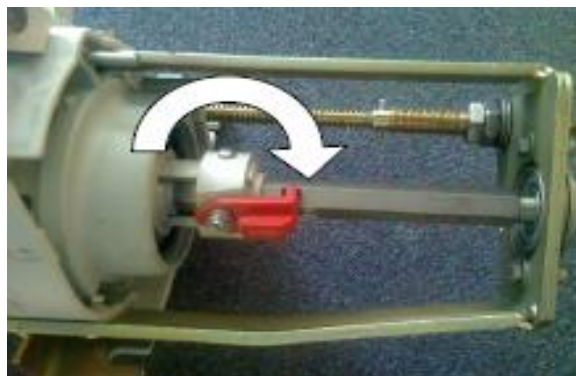
Obr. 33 – Nastavení turniketu dávkovače
